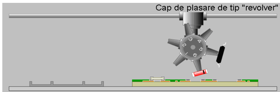
Fig. 4: Secvențe din filmul proceselor de culegere și plasare ale componentelor: b) în timpul procesului de plasare, după ce toate componentele au fost colectate și prima din ele plasată
